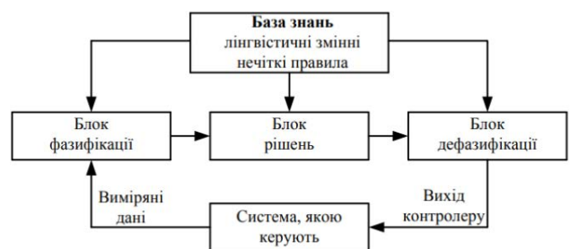
Рис. 5. Загальна структура нечіткого регулятора
